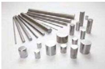
●特殊鋼線材または棒鋼を素材に、冷間引抜製品を始め、表面キズゼロを保証するピーリング(研削)製品や長尺センタレス(研磨)製品と、それらに切断・面取等の加工を施してお客様の用途やご要望に応じて高品質・高精度の磨棒鋼製品をお届けしています。
